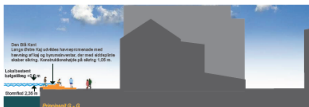
Variant 2 - skråning med byromsventiler
